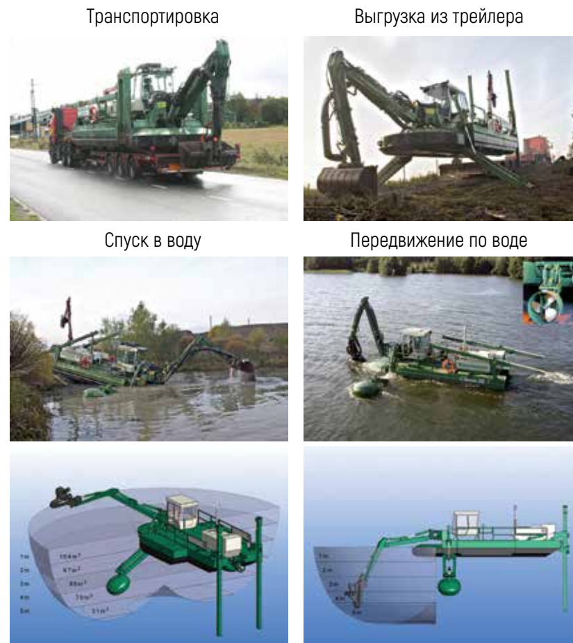
Рис. 24. Преимущества земснаряда Watermaster Classic III
