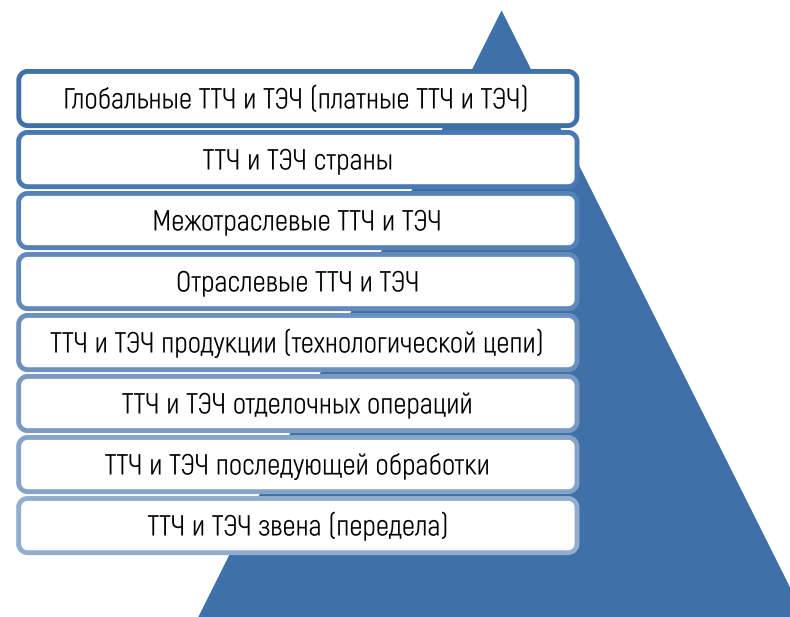
Рис. 35. Иерархическая восходящая структура ТТЧ и ТЭЧ
