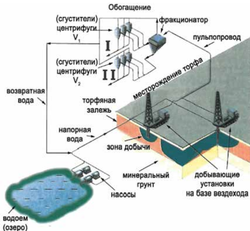
Рис. 21. Модульная схема скважинной гидродобычи торфа
