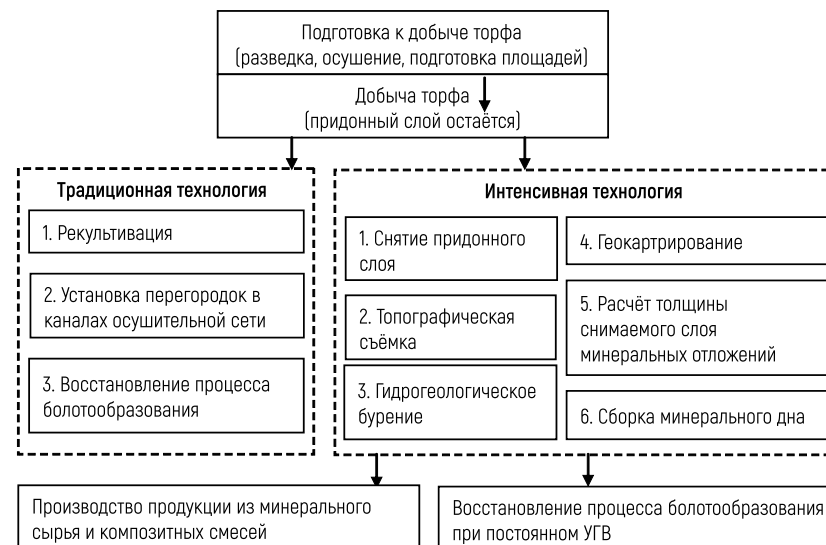
Рис. 33. Принципиальная схема комплексного использованию ресурсов торфяных месторождений
