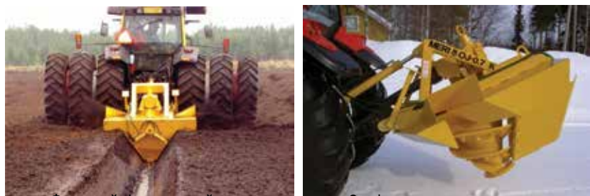
Финский фрезерный каналокопатель Suokone для рытья канав на торфяных полях OJ-0.7 К, OJ-1.0 К и OJ-1.3 К
